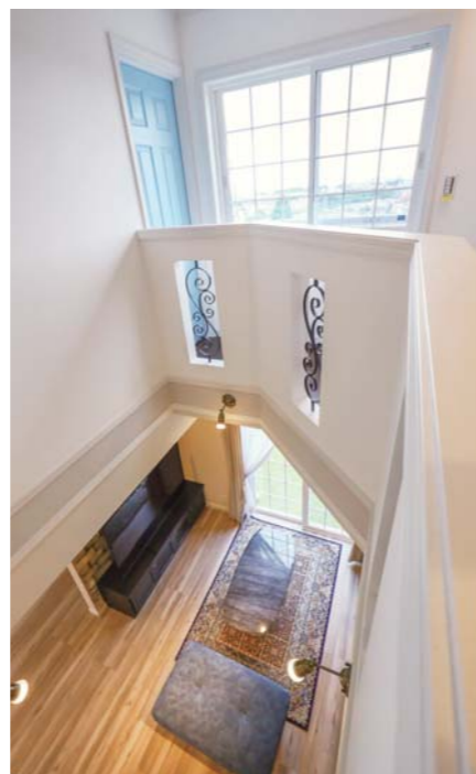
吹き抜けを介して爽やかな光が住まいを循環する。2階ホールの腰壁には、採光を意識してスリットを入れた。
